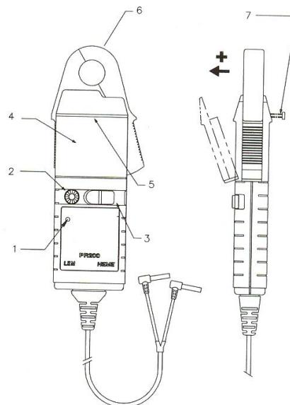
Proudová sonda je napájena 9V baterií. Výdrž baterie je obvykle 50 hodin. Pokud bliká červená dioda led, je potřeba co nejdříve baterii v proudové sondě vyměnit.
