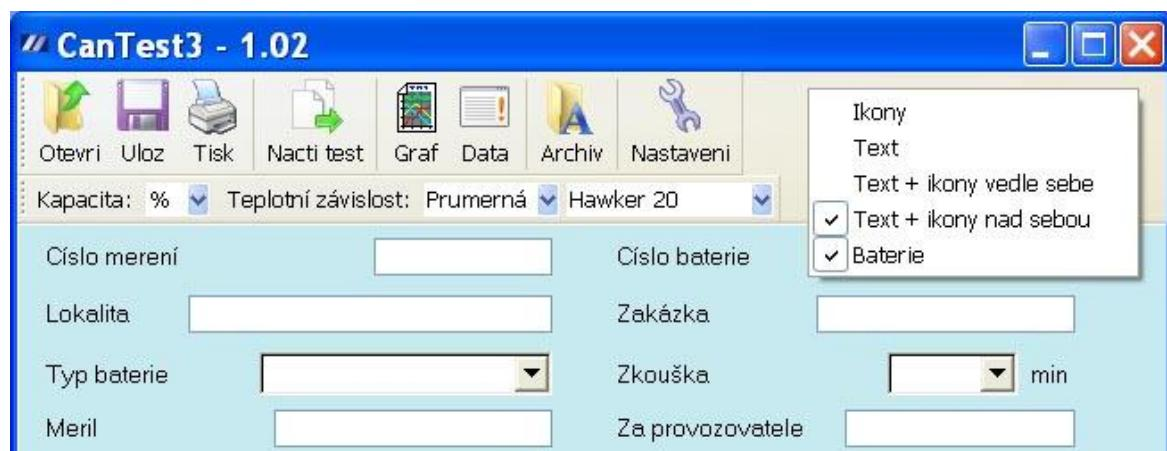
Pomocí pravého tlačítka v nástrojové liště lze měnit zobrazení nabídek a zobrazovat či skrývat vlastnosti baterií.
