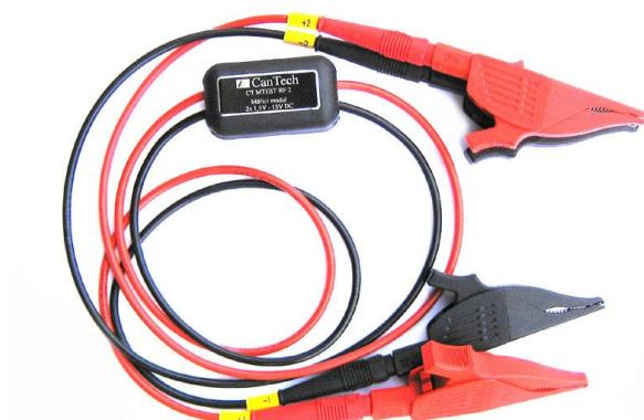
CT MTEST RC2 se používá pro měření dvouvoltových článků. Oproti RC1 je méně univerzální - je potřeba vždy zapojit na dvě po sobě jdoucí baterie zapojené v sérii.
