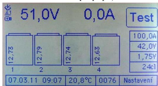
údaj na displeji). Hodnoty z bezdrátových měřicích modulů se načítají každých 18 sec. (při testu se doba může zkrátit - záleží na počtu měřicích modulů). Velikost volné paměti se zobrazí po stisku čísla testu (0076 - viz údaj na displeji). Bezdrátový měřicí modul nemá žádné vlastní napájení - je napájen přímo z měřené baterie (spotřeba pouze 10mA - nemá vliv na měření). V případě, že se objeví na druhém
