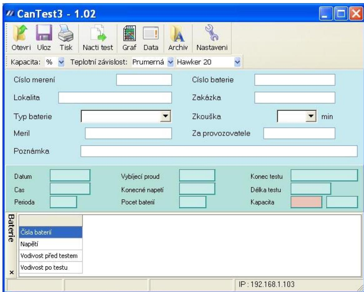
Úvodní obrazovka programu CanTest3 slouží k zadání doplňujících informací testu, výběru typu testu a teplotní závislosti a uložení dalších vlastností baterií.
