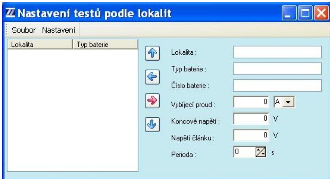
Po vyplnění údajů v pravé části okna je potřeba šípkou "vlož" založit řádek v levé části okna, potom se mohou znova v pravé části zapsat další údaje a znova vložit. Tyto údaje se potom přes "Nastavení - Pošli" uloží do testeru ( tester musí být propojen s PC přes USB nebo Ethernet ), kde se výběrem testované lokality automaticky nastaví tyto údaje viz. kapitola č. 10 - Lokality.
